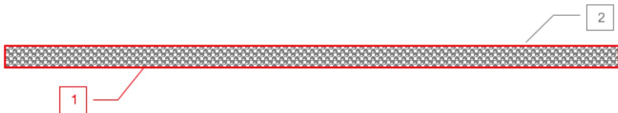
**1) Trägerelement des Entkopplungselement für den Ansetzmörtel**
